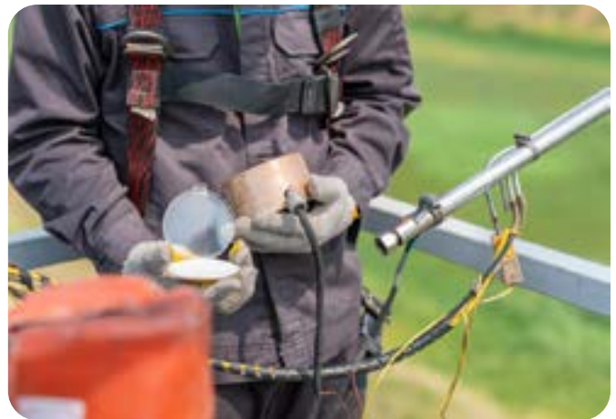
Rysunek 4. Próbkobiorca składający sondę poboru próbek i filtr wlotowy do pobierania próbek do kanistra metodą OTM-50
